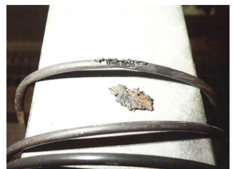
保温材が付着し損傷したOリング
